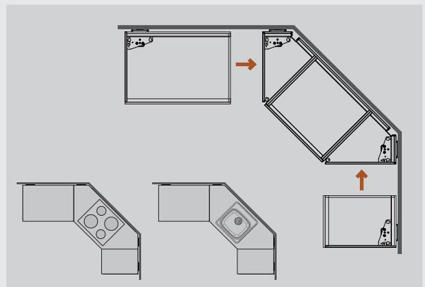
El módulo esquinero está equipado con dos motores y se puede utilizar como una unidad. Complemente con módulos adicionales para obtener la longitud deseada en el ala izquierda y derecha, respectivamente. Puede colocar una placa o un fregadero en la esquina.
