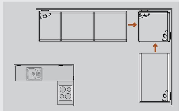
El módulo esquinero está equipado con dos motores y se puede utilizar como una unidad. Complemente con módulos adicionales para obtener la longitud deseada en el ala izquierda y derecha, respectivamente. Puede colocar fregadero y placa de cocción en los módulos adicionales.
